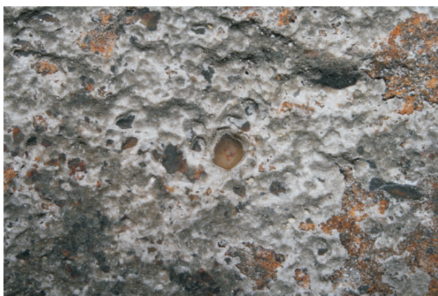
Obr. 4. Sádrovcové eflorescence vysrážené na zbytku pevné krusty na povrchu pískovce při pravém okraji převisu (24.12.2011).
